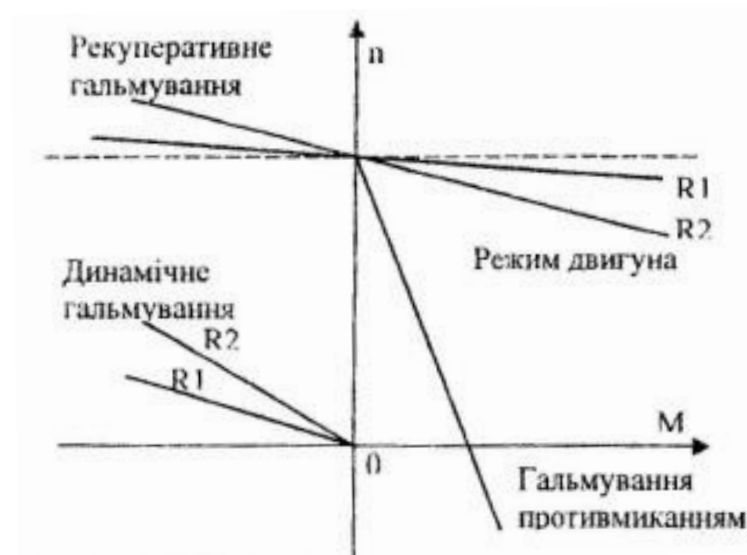
Рис. 2.2. Механічні характеристики двигуна при різних режимах роботи
